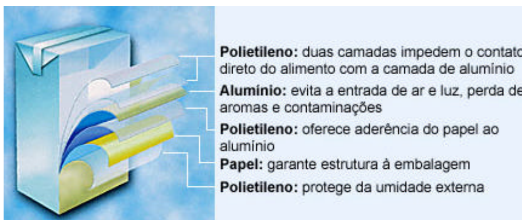
Figura 12 : Composição da Embalagem Asséptica. – Fonte: ABLV – Associação Brasileira de Leite Longa Vida.
